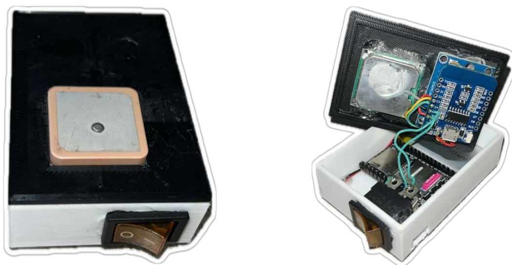
3.6-сурет – Жобаланған GPS трекері
